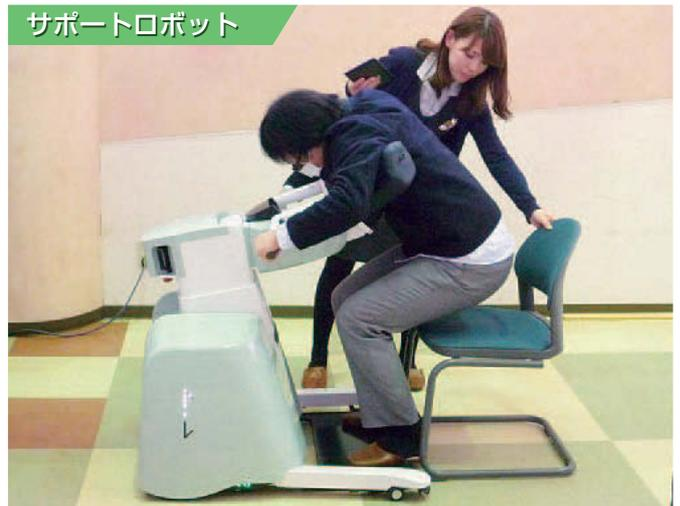
自立した生活への意欲向上と介護する方の負担軽減を目的として、体の自然な動きに合わせて起立と着座をサポートする介護ロボットです。使用する方の起立する力を検出して、ロボットがサポートする力を一人ひとりにあった設定に変更することができます。
