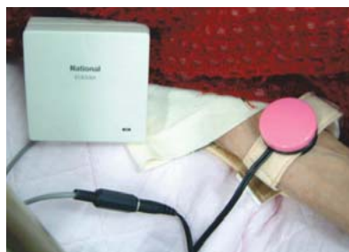
スイッチ接続可能な呼び出し装置（松下電工製）と手首スイッチの利用
